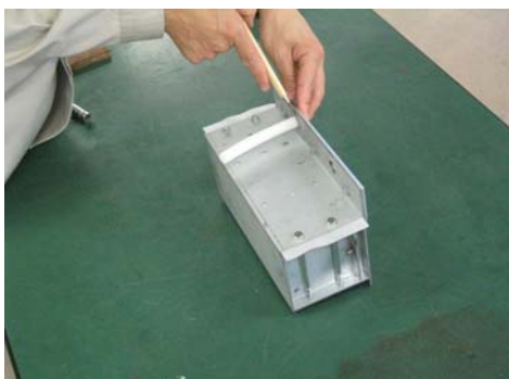
写真 17 シール材の切断
