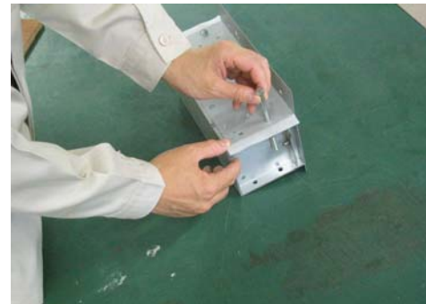
写真6 長ボルトの差込み
