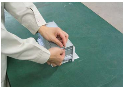
写真7 短ボルトの差込み
