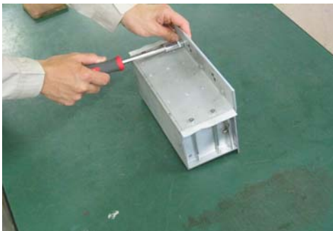
写真 15 スリット板の固定②
