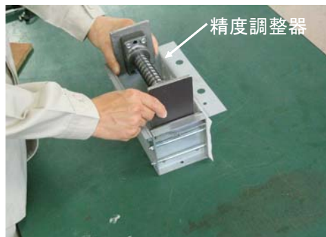
写真8 型枠精度調整器のセット
