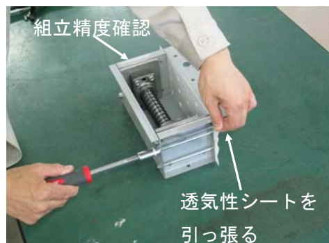
写真10 側板と端面板の固定
