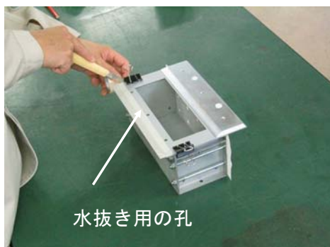
写真 19 テーピング材の切断
