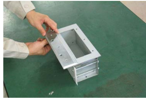
写真 14 スリット板の固定①
