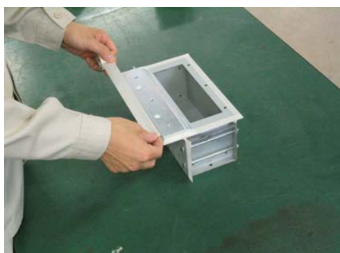
写真 21 スリット板のテーピング
