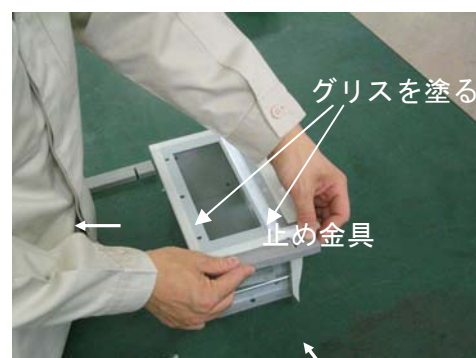
写真 24 パッキンの取付け
