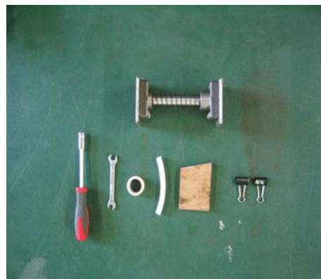
写真3 ボス型枠組立て時の工具
