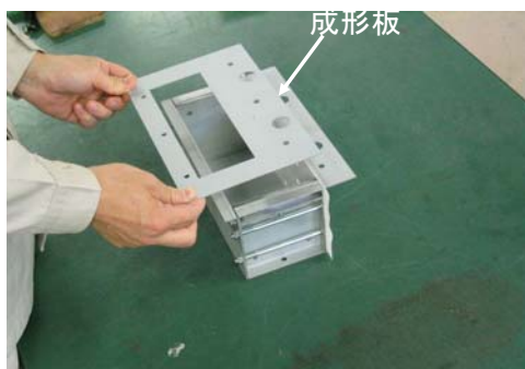
写真11 成形板のセット①
