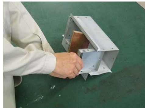
写真4 端面板のセット②
