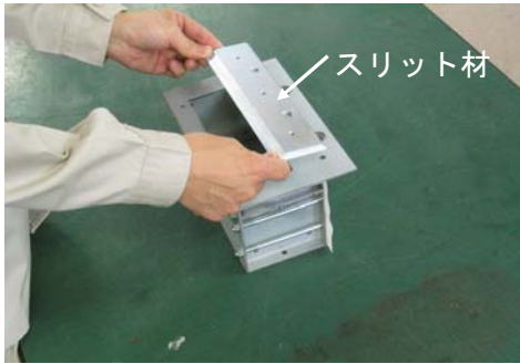
写真 13 スリット板のセット
