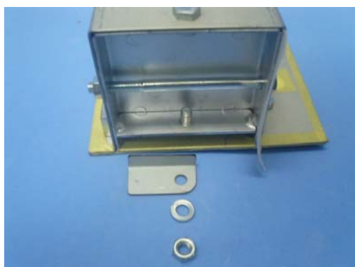
写真 23 止め金具の取付け
